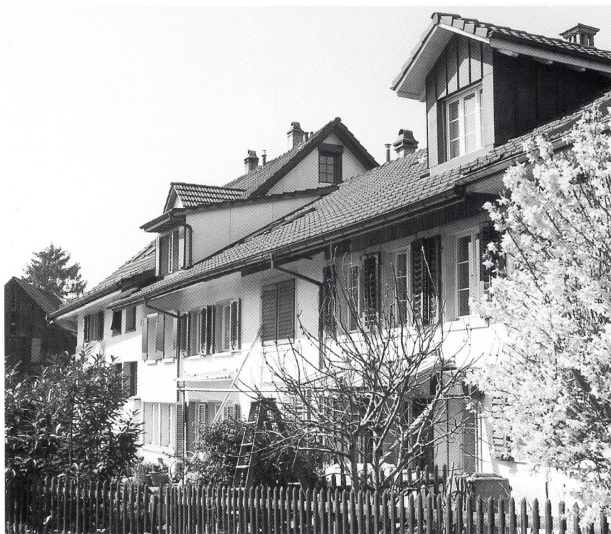
Das schwach geneigte «Tätschdach» der mittleren Hausteile beim Reihenflanz im Rad in Stäfa war ursprünglich mit Holzschindeln eingedeckt, das steilere Dach des jüngeren Hausteils ganz links von Anfang an mit Ziegeln. (Foto: Ueli Gantner, Üriikon)
